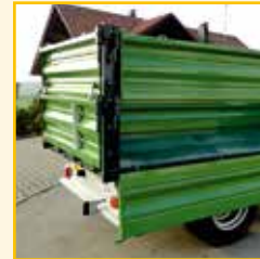
Bordwand geteilt aufklappbar oder pendelbar
