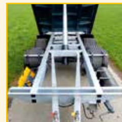
Parallelrahmen mit integriertem Kippträger
