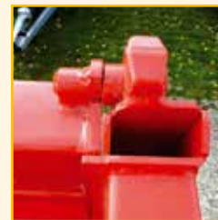
Pendelverschlüsse vorne, Bordwandprofil gleiche Stärke wie seitlich
