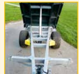
V-Rahmen mit integriertem Kippträger
