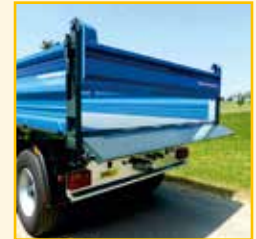
Sehr stabile hydraulische Hardoxklappe
