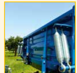
zwei Hebefedern je Seite Zentralverriegelung Selbstreinigendes Brückenprofil
