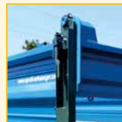
Erhöhte Kipplager an der Pendelklappe
